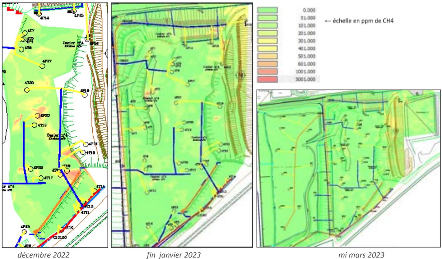
La première phase du plan d'action a traité les sources les plus émissives (densification des réseaux de captage du biogaz, pose de GSB en crête de talus des C4A4 C4A5 ) et a eu un impact significatif sur la réduction des émissions diffuses de méthane (cf. présentation de ValorCaux à la CSS du 13/04/2023 disponible sur [www.ecauxpole.fr/publications](http://www.ecauxpole.fr/publications)).
