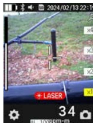
Exemple de photo prise au moyen du laser méthane
