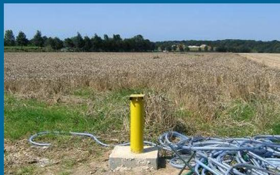
Un piézomètre est un forage crépiné, à l'intérieur du sol, permettant d'atteindre la nappe souterraine.
